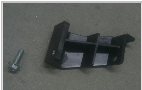
1.28 将六角头螺栓(全螺纹) M6_20 安装在支架上
