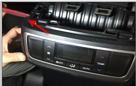
1.11 然后用翘板撬起如图示意位置卡扣，左右两边同样位置，拆后盖时，注意原车显示屏里面线束插头
