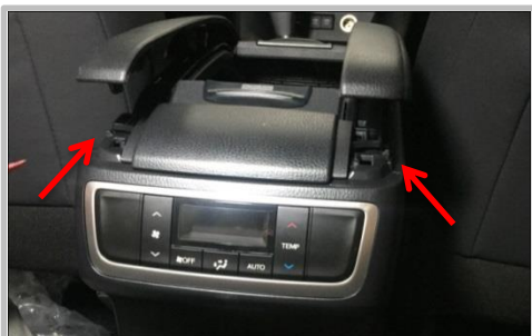
1.9 用撬板将手扶箱上盖从边角撬起来如图示意左右两边已撬起
