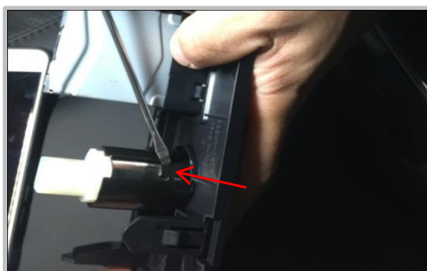
1.18 用一字螺丝刀撬开原车点烟器支座上卡扣（箭头指向卡扣），
