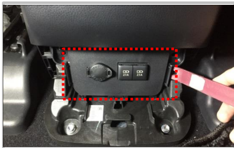
1.6 拆下虚线框示意装饰件, 注意内部有线束接头
