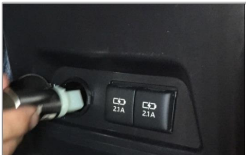
1.26 先安装原车点烟器支座, 然后将点烟器芯安装在点烟器支架上
