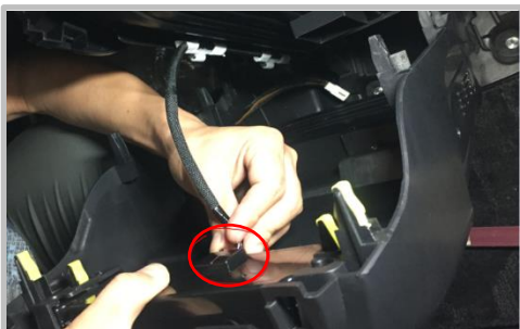
1.39 安装净化器之前将原厂显示屏插头插好
