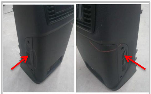
1.34 安装我司净化器前，拆下净化器上左右两边进风格栅
