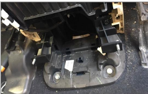
1.33 如图示意，左右支架已安装好
