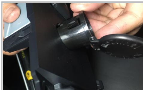
1.20 再把点烟器支座拆下
