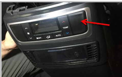
1.27 将原车显示屏(箭头指向)安装我司净化器上
