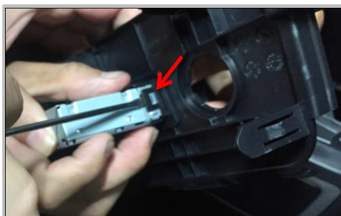
1.22 用一字螺丝刀撬开原车 USB 左右两边卡扣（15+款汉兰达没有 USB）
