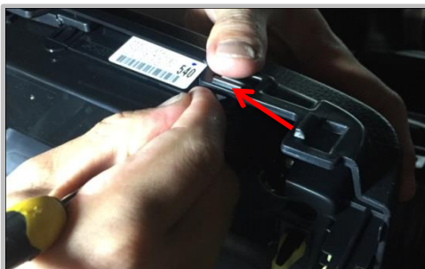
1.13 用一字螺栓刀撬开卡扣，左右两边同样位置需拆下卡扣
