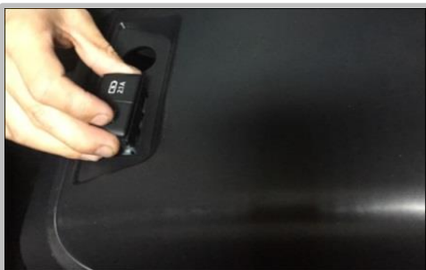
1.25 18 款有 USB, 先将小盖拆下, 将 USB 安装在净化器上
