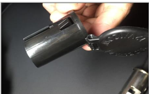
1.21 如图示意原车点烟器支座已拆下
