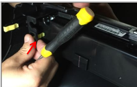
1.14 然后把箭头位置黄色卡扣往里推，左右两边卡扣同样往里推
