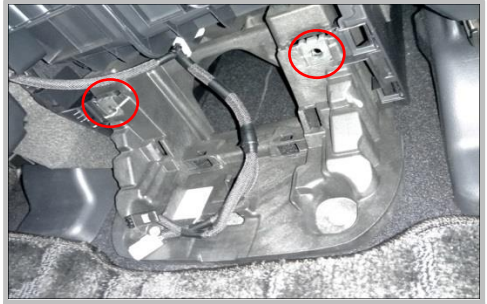
1.30 将支架安装在这两个孔位置。
