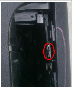
1.37 将 SIM 卡安装在净化器上
