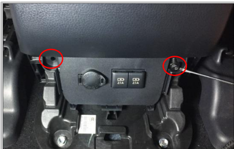
1.5 拆下圆圈位置左右两颗螺钉, 后续安装净化器用回这两颗自攻钉
