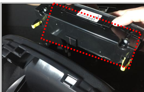
1.15 如图示意显示模块已拆下
