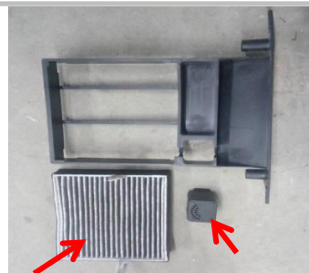
1.44 安装左边格栅前，将滤芯和香薰安装在格栅上
