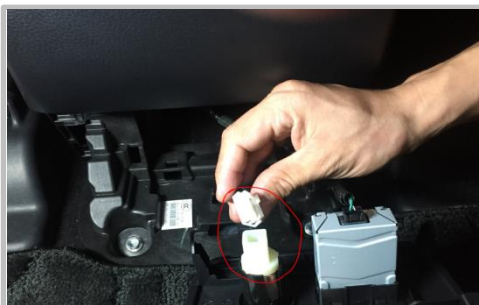
1.41 安装净化器之前将点烟器插头插好
