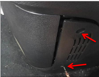
1.51 用拆下两颗螺钉将右边进风格栅固定在净化器上
