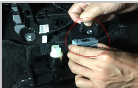
1.40 安装净化器之前将原厂 USB 插头插好
