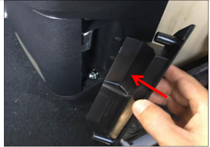
1.50 将右边进风格栅安装在净化器上
