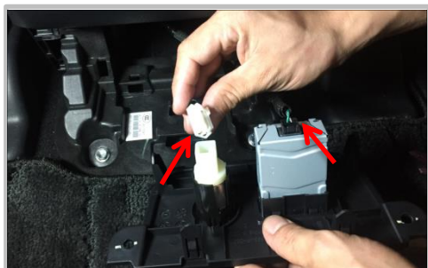
1.8 点烟器插头和 USB 插头拔出
