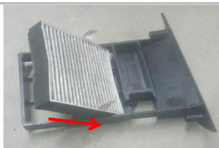
1.45 滤芯按照箭头方向安装在左边格栅上
