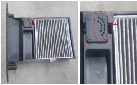
1.47 香薰孔的位置朝向滤芯方向（按箭头指示方向）
